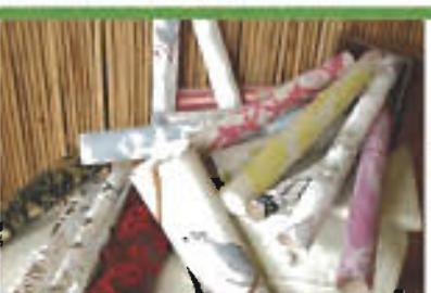
تحقیقان مؤسسه تکنولوژی کارلسروهه آلمان با استفاده از الیاف شیشه ای با مقاومت بالا که به یکدیگر بافته شده اند، یک پوشش الاستیک بسیار قوی تولید کرده اند که میتواند انرژی ناشی از زلزله را به چهار جهت منتقل کرده و مانع از فرو ریختن دیوار شود.
